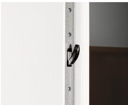
8. Mehrfachsicherheitsschloss mit Schwenkriegel (nur für Einbruchhemmung RC3 in Verbindung mit Doppelfalz) Als Standard wird geliefert: Mehrfachverriegelung mit Rundbolzen
